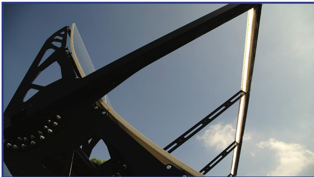
Il grado di concentrazione è di 144 volte, costante a qualsiasi ora dell'anno, dall'alba al tramonto. In questo modo è possibile non solo produrre energia termica, ma anche garantire temperature elevate, che possono raggiungere i 100° ed oltre, a seconda del modello di impianto installato.
